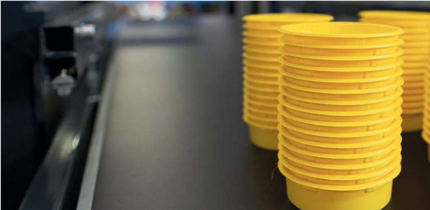
Im Thermoform-Verfahren fertigt Pöppelmann großformatige und gleichzeitig dünnwandige Schutzelemente, die stapelbar sind.
