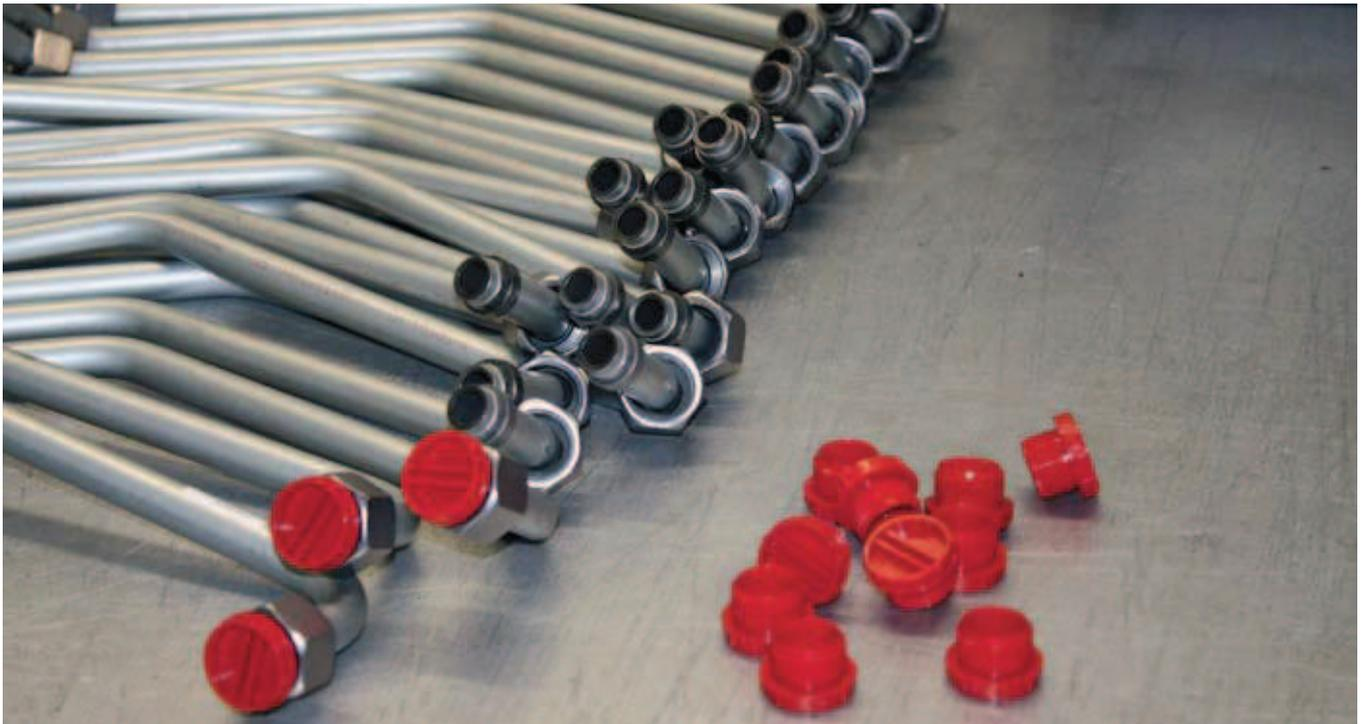
Die Stopfen werden manuell auf die Gewinde gestülpt oder geschraubt und schützen diese zuverlässig vor Beschädigung und Verschmutzung.
